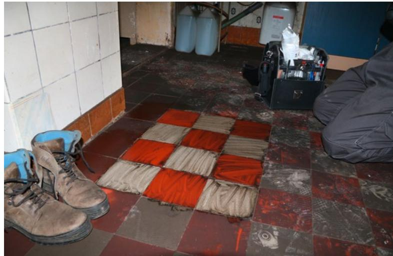
Untersuchung eines Brandfolgeschadens: Die Ablagerungen, die jede waagerechte Oberfläche bedecken, werden beprobt.
